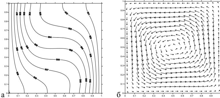
Рис. 1. Изотермы (а) и линии тока (б), полученные при тестировании,  $Pr = 0,7$ ,  $Ra = 10^4$
